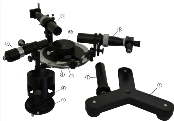
Spectrogoniomètre OIG330 et ses principaux éléments
