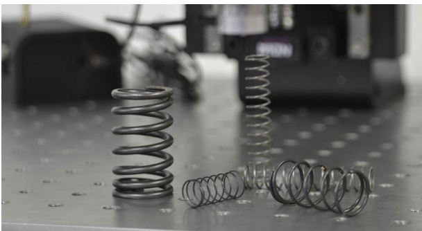
Essais en compression de ressorts amortisseurs
