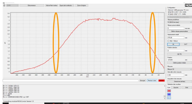
Acquisition de Bz avec la sonde traversant une bobine de Helmholtz
