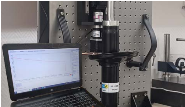
Compression d'une suspension avec jauge de compression 500N. Platine de translation fixée parallèlement au plan de la breadboard. Utilisation de la breadboard à la verticale. Nécessite 4 équerres. Vérification de la loi de Hooke et calcul du module de Young.
